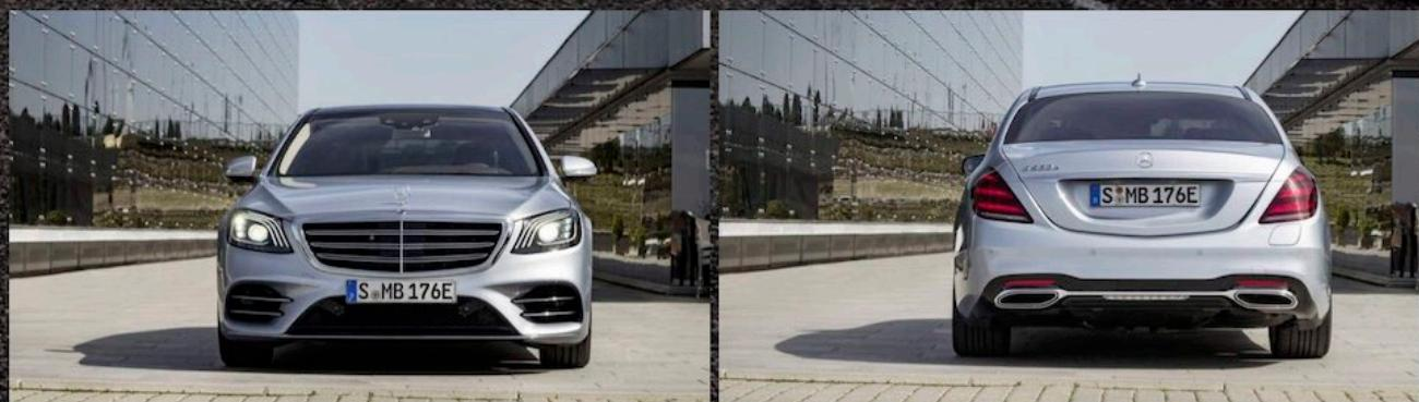
با ۳۶۷ اسب بخار قدرت و ۵۰۰ نیوتن‌متر گشتاور به همراه یک موتور الکتریکی با V6 به یک پیشرانه‌ی ۳ لیتری ۱۲۱ اسب بخار قدرت مجهز شده است. مجموع خروجی این سیستم ۴۷۶ اسب بخار قدرت و ۷۰۰ نیوتن متر گشتاور است که توسط یک جعبه‌دنده‌ی ۹ سرعته خودکار به چرخ‌ها انتقال پیدا می‌کند. قدرت این مدل جدید به میزان قابل توجهی بیشتر هم نیروی ۴۳۶ اسب بخار قدرت و ۶۵۰ نیوتن متر گشتاور است و حتی از مدل بنزینی S500 از بیشتری دارد.
