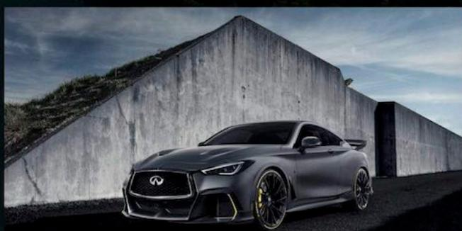
این مدل مفهومی از سه واحد MGU مشابه خودروهای فرمول یک استفاده می‌کند؛ علاوه بر این یک واحد MGU-K نیز برای بازیابی انرژی هدررفت ترمزگیری و دو واحد MGU-H برای بازیابی انرژی حاصل از حرارت تولیدی اگزوز هم در مجموعه قوای فنی استفاده شده است. تمام انرژی بازیابی شده در باتری لیتیوم-یون ۴.۴ کیلووات ساعت، ذخیره می‌شود تا در شرایط نیاز، برای افزایش قدرت تا ۱۶۰ اسب بخار و چرخاندن سریع‌تر پرهای توربوشارژر، وارد عمل شود.
