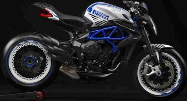
سرگزوهای سهتایی سنتی بروتاله نیز به پوشش محافظتی سرامیک برای مقاومت بیشتر در برابر دمای بالا، مجهز شده است. این مدل تولید محدود ویژه، در بخش قوای فنی تغییری نکرده است و همچنان از پیشرانه‌ی ۳ سیلندر ۷۹۸ سی‌سی، با قدرت ۱۴۰ اسب بخار (دور موتور ۱۲۳۰۰)، گشتاور ۸۷ نیوتن‌متر (دور موتور ۱۰۱۰۰) و نهایت سرعت ۲۴۴ کیلومتر بر ساعت استفاده می‌کند.
