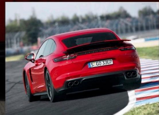
با توجه به اینکه GTS باید مدل میانه‌ی پانامرا باشد، نهایت قدرت V8 آن به ۴۶۰ اسب بخار محدود شده است. جعبه‌دنده‌ی دو کلاچه‌ی ۸ سرعته و سیستم انتقال قدرت تمام چرخ محرک (AWD) مسئولیت مدیریت و کنترل ۶۰۰ نیوتن‌متر گشتاور (دور موتور ۱۸۰۰ تا ۴۵۰۰) این سدان و استیشن اشتونگارتن را پذیرفته‌اند. هر دو مدل سدان و استیشن پورشه پانامرا GTS در زمان ۴.۱ ثانیه به سرعت ۱۰۰ کیلومتر بر ساعت می‌رسند، اما نهایت سرعت مدل سدان با ۲۹۱ کیلومتر بر ساعت، یک کیلومتر بر ساعت بیشتر از استیشن پانامرا GTS است.
