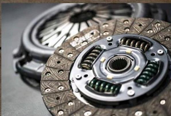
وضعیت دیگری که می‌تواند باعث وارد شدن فشار بیشتر به قطعات کلاچ شود زمانی است که راننده پای خود را روی آن می‌گذارد. این موضوع معمولاً زمانی رخ می‌دهد که راننده پای خود را پس از تعویض دنده به طور کامل از روی کلاچ برنداشته بنابراین این پدال کاملاً درگیر نشده است. شاید دلایل محدودی برای این کار وجود داشته باشند اما باید از انجام آن دوری کنید.
