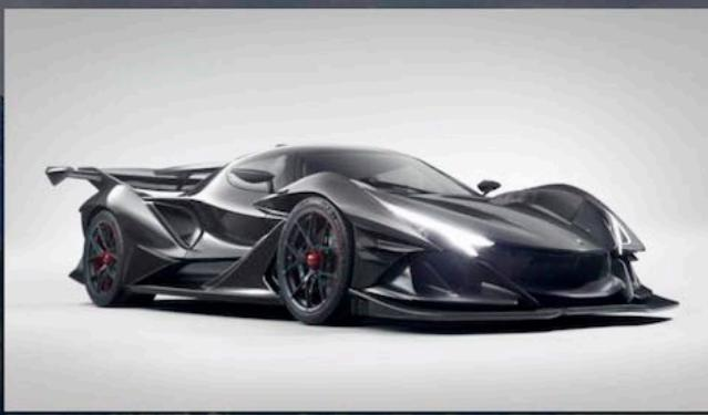
این هایپرکار از پیشرانه 6.3 لیتری با قدرت 780 اسب بخار و 759 نیوتون متر گشتاور استفاده می‌کند. این قدرت به همراه وزن کم 1250 کیلوگرمی که به لطف استفاده از فیبر کربن زیاد در شاسی و بدنه حاصل شده باعث می‌شود بهترین فرمول ساخت یک هایپرکار به دست آید. حداکثر سرعت EA برابر با 333 کیلومتر در ساعت اعلام شده است.
