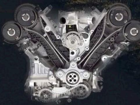
1 - اگر موتور خودرو از نوع Interference (تداخلی) باشد پس از بریدن تسمه پیستون به سوپاپ برخورد کرده و آسیب جدی به موتور وارد می کند.
